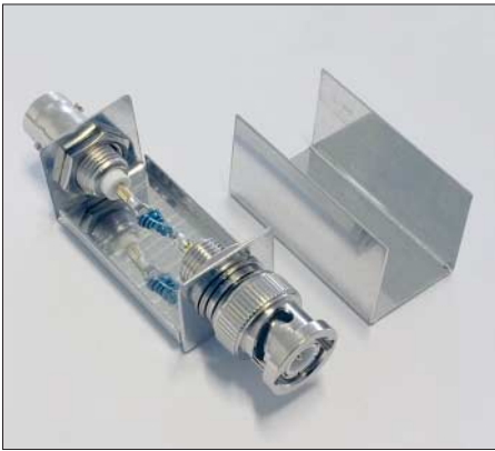
Bild 13: 50-Ω-Längswiderstand (zweimal 100 Ω parallel) im Weißblechgehäuse, Bausatz FA-Nr. BX-068
