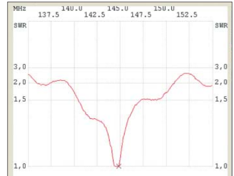
Bild 12: SWV-Verlauf einer 2-m-/70-cm-Duo-bandantenne X30 im 2-m-Bereich nach 15 m Ecoflex 10 (0,7 dB Dämpfung auf 2 m); zusätzlich erkennbar sind Resonanzen der elektrisch fast 9 \lambda langen Speiseleitung.
